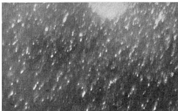
Abb. 8. Elektronenbild einer Kollodiummembran (Ultrafilter). Durchmesser der Poren: 50—250 mμ. U = 76 kV; Elektronen-V 1200:1. Licht-V 2,65:1, Gesamt-V 3200:1.
